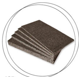
ICB (Aglomerado de Cortiça Expandida) condutibilidade: 0,045
